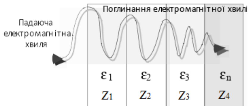
Рисунок 4.20 – Схема дисипації електромагнітної хвилі в градієнтному радіопоглинаючому матеріалі
